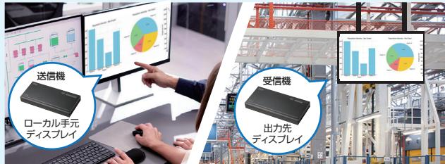
送信機側にもHDMI出力機能を搭載しており、延長先に映し出される映像を手元でも確認ができます。
